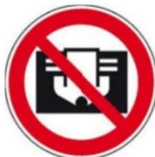
**Attention :** Pour éviter une surchauffe du panneau chauffant, il est interdit de le recouvrir.
